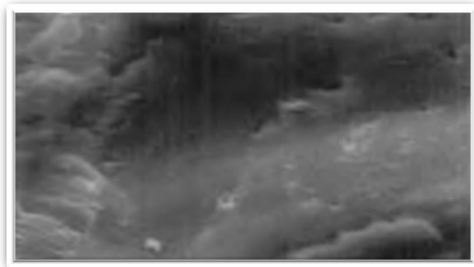
Cemento con NovoCrete® estructura densa, cerrada
